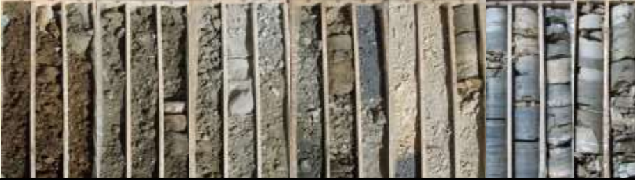
Bohrkerne einer Rotationskernbohrung
