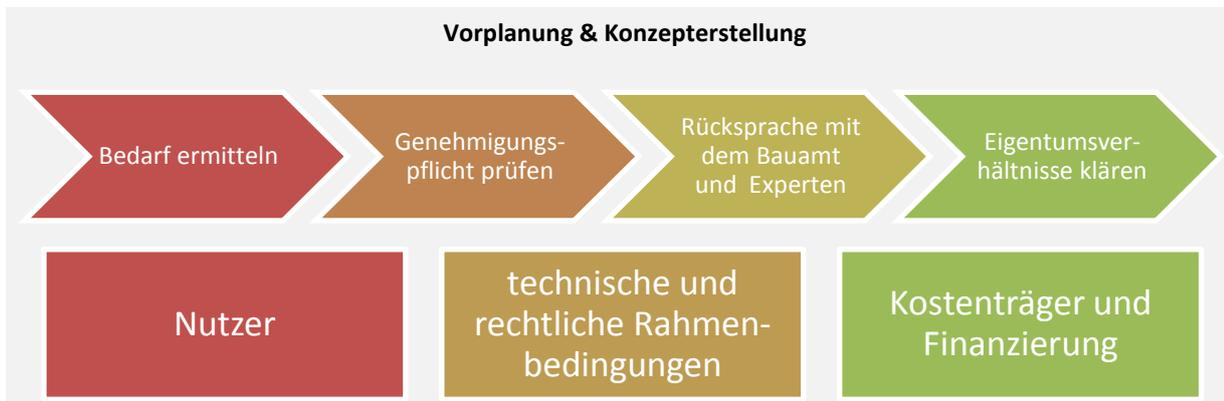
Abbildung 8: Schematischer Ablauf eines Vorplanungs- und Konzeptionsprozesses für Ladeinfrastruktur, nach (18)
