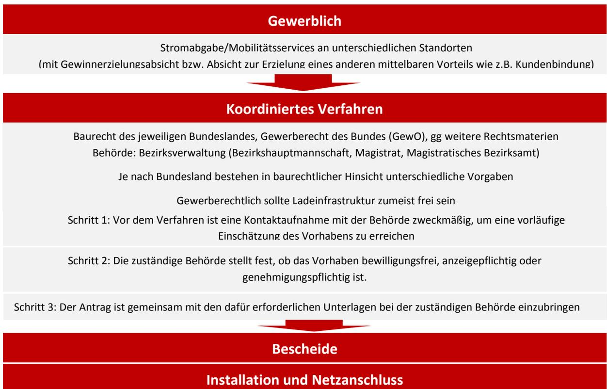
Abbildung 9: Prozessdiagramm zum Ablauf des baurechtlichen Genehmigungsverfahrens von gewerblich betriebener Ladeinfrastruktur (33)
